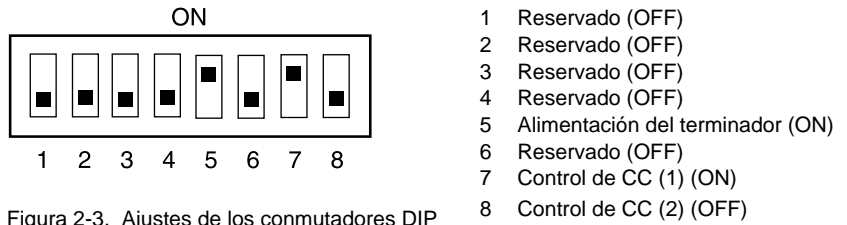
Figura 2-3. Ajustes de los conmutadores DIP
