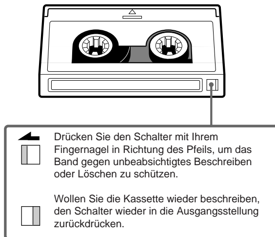
Abbildung 4-1. Schreibschutzschalter
