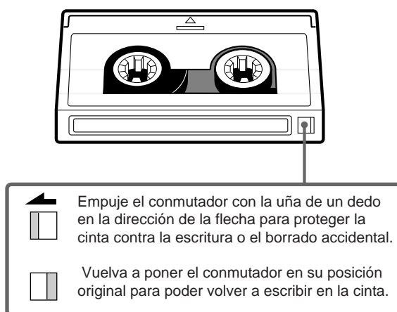
Figura 4-1 Conmutador de protección contra escritura
